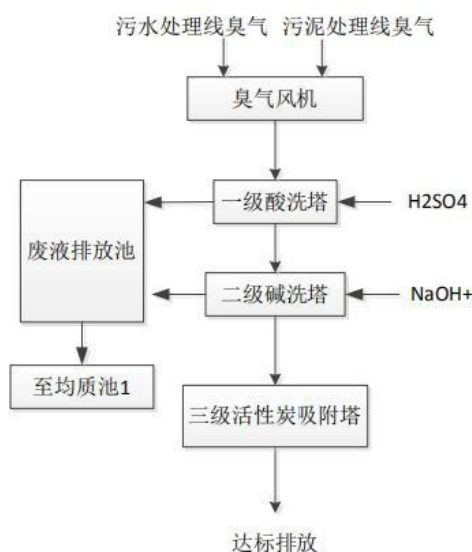
图 6.1.6-6 废水除臭系统工艺流程图
