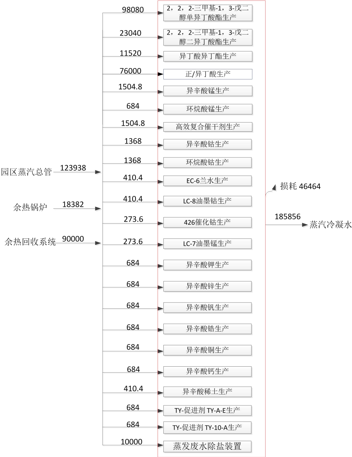
图 3.5-1 本项目蒸汽平衡（单位：t/a）
